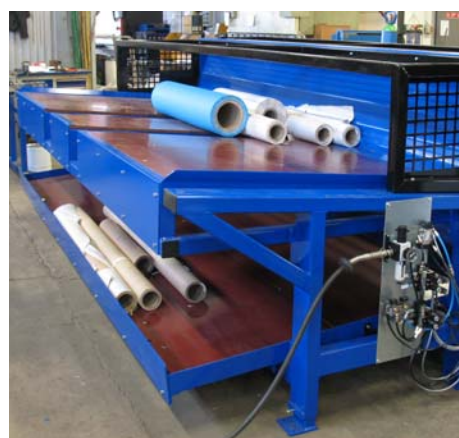
Hylsrensaren kan användas till smårullar med tidningspapper, finpapper, kartong mm.
