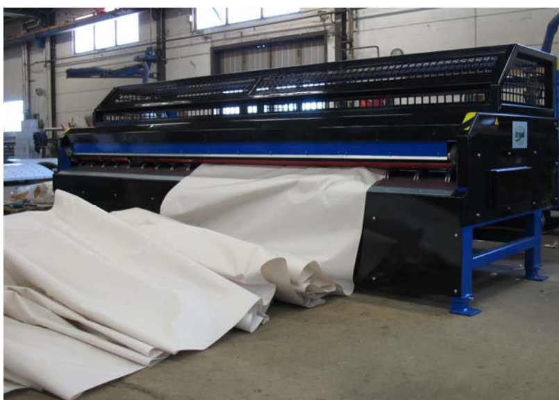
Hylsrensaren kan användas till smårullar med tidningspapper, finpapper, kartong mm.
